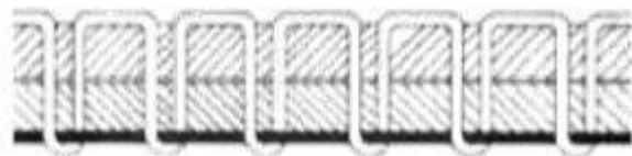
Рис б : слишком низкое натяжение иглы или слишком высокое натяжение при вращении.
